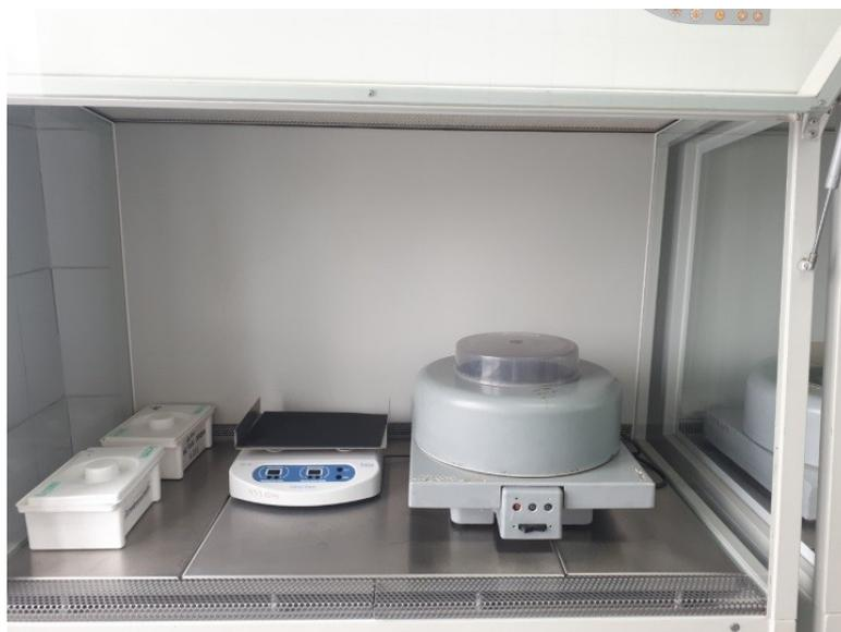
Вошер планшетный PW 40 (8-ми канальный) – прибор для промывки планшеток после завершения исследования.
