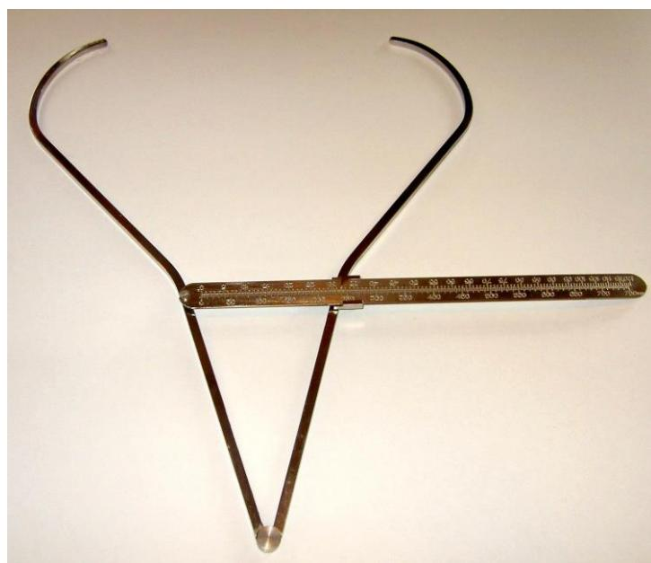
Рис. 2. Большой толстотный циркуль
