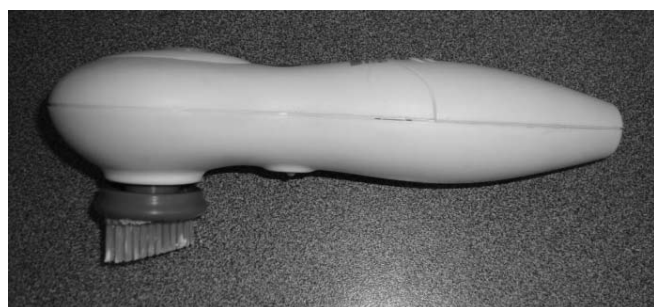
Рис. 1. Установка для обработки пломбировочного материала зубной щеткой с зубной пастой.
