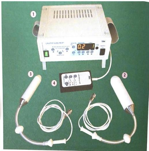
РИС. 7. Аппарат «ИНТРАВИБР» для вибромагнитного воздействия вагинально с управляемой частотой и амплитудой вибрации: 1 — электронный блок аппарата «ИНТРАВИБР»; 2 — вагинальный инструмент-вибратор № 1, диаметр 34 мм; 3 — вагинальный (ректальный) инструмент-вибратор № 2, диаметр 25 мм; 4 — выносной пульт управления
