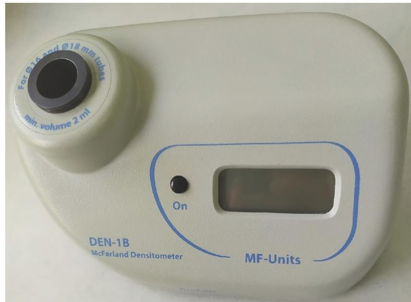
Рисунок 3 - Денситометр DEN-18 - для измерения концентрации клеток (бактериальных, дрожжевых) в клеточной суспензии
