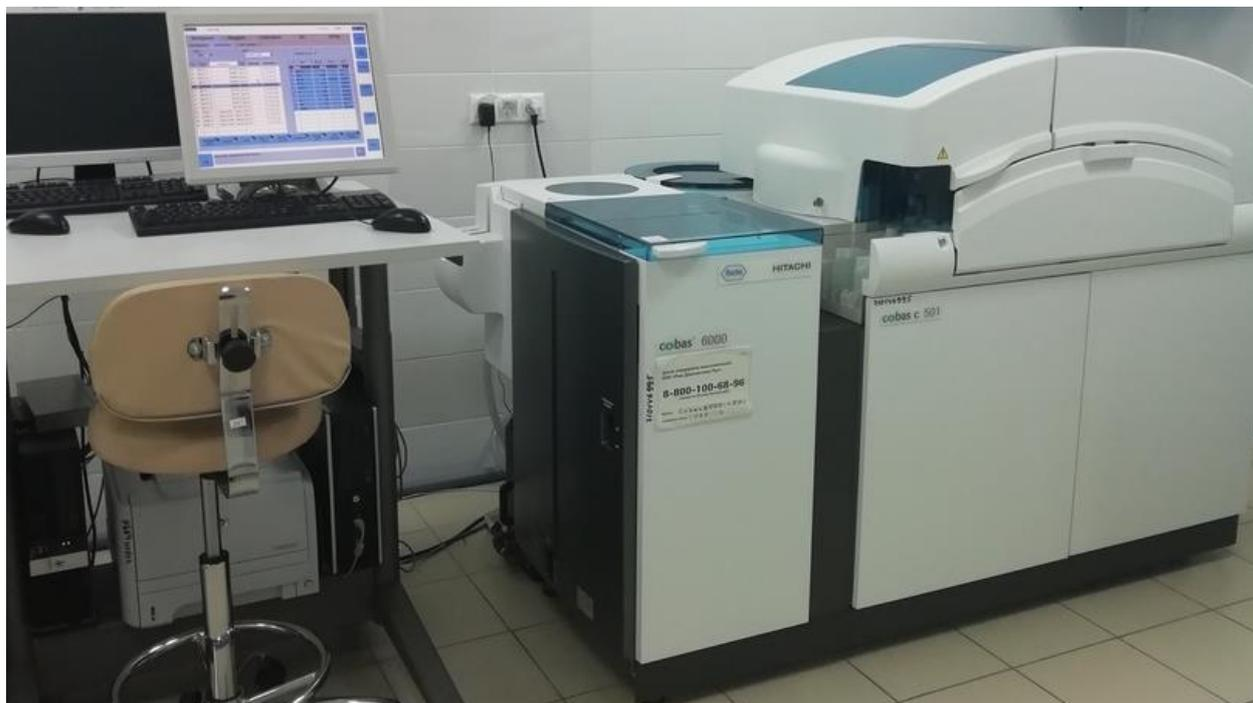
Рис.6 - Биохимический анализатор Cobas 6000
