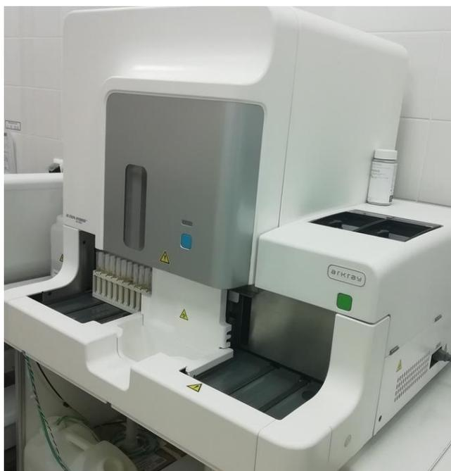
Рис. 3 Общеклинический анализатор Aution Hybrid 4050
