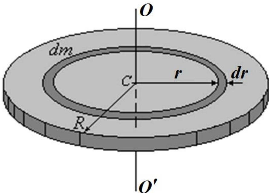
Разобьем цилиндр на отдельные полые концентрические цилиндры бесконечно малой ширины  $dr$  и радиусом  $r$ . Момент инерции такого цилиндра равен:
