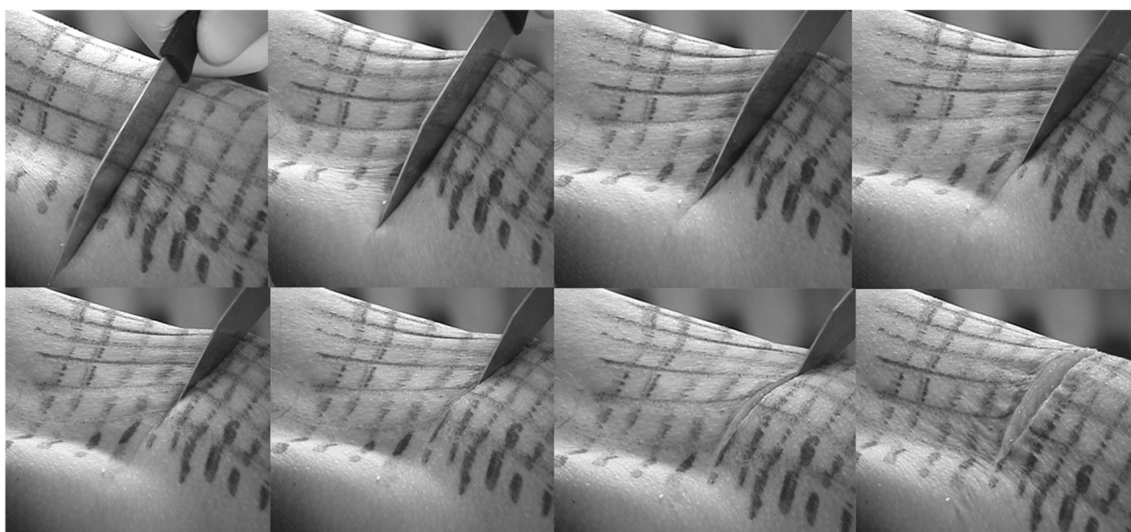
Рис. 3. Покадровое воспроизведение процесса резания «коротким» ножом на поверхности бедра (время одного кадра 0,04 сек.).
