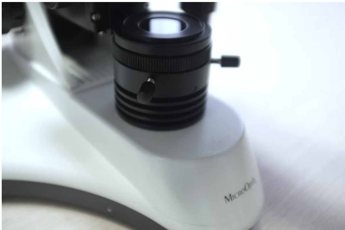
Микроскоп с системой освещения по Келеру с линзой, полевой ирисовой диафрагмой и механизмом центрирования.
