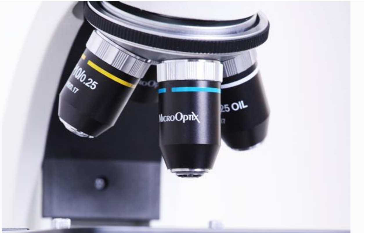
Биологический микроскоп с 4 полуплан ахромат объективами: 4x/0,10, 10x/0,25, 40x/0,65, 100x/1,25
