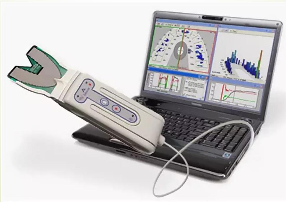
T-Scan III — диагностический прибор, который определяет и анализирует силу сжатия зубов, групп зубов и зубных рядов, используя одноразовые датчики.
