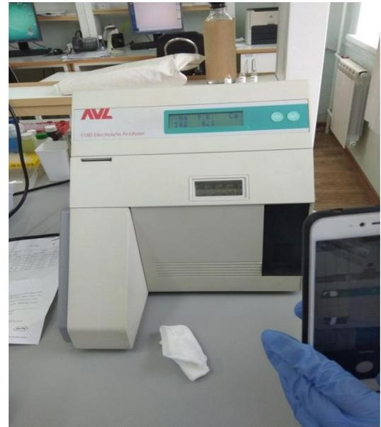
Затем к специальному шприцу подносят вакутенер с отцентрифугированной кровью, аппарат делает забор сыворотки, и в течение 50-ти секунд исследует её. После выдаёт чек с результатами исследования.
