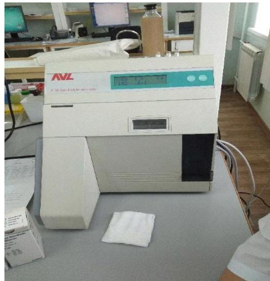
Каждый электрод имеет ионоселективные мембраны, которые выполняют специфические реакции с соответствующими ионами, находящимися в анализируемом образце. Электролитный анализатор производит забор образца непосредственно из шприца, пробирок, флаконов.
