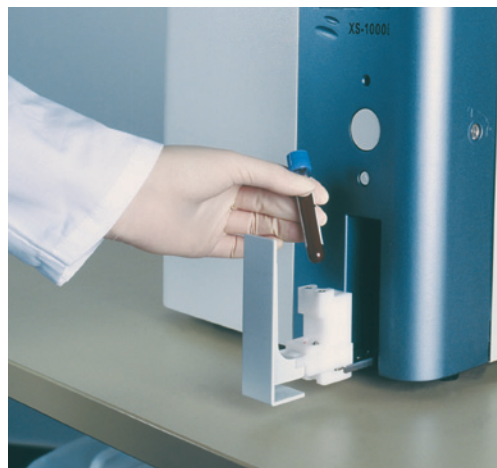
Рис. 9 XS-1000i: Закрытое положение образца для прокалывания крышек пробирок.
