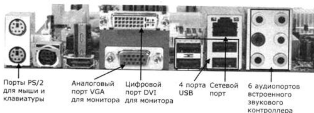
Рис.5. Задняя панель разъемов современной материнской платы
