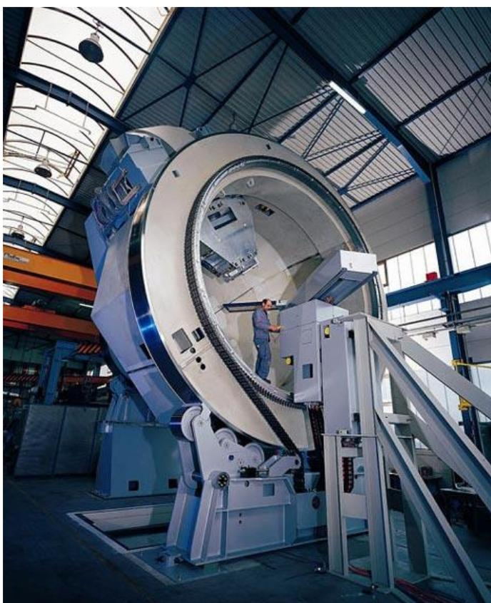
Рис. 4. Циклический ускоритель для лучевой терапии протонами высоких энергий.
