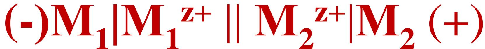
Одной линией обозначают границы фаз типа «твердое тело — твердое тело» и «твердое тело — жидкость». Двумя линиями (или одной штриховой) — границу раздела двух растворов, т.е. положение электролитического мостика.
