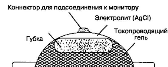
Рис. 6-17. Поперечный разрез хлорсеребряного электрода
