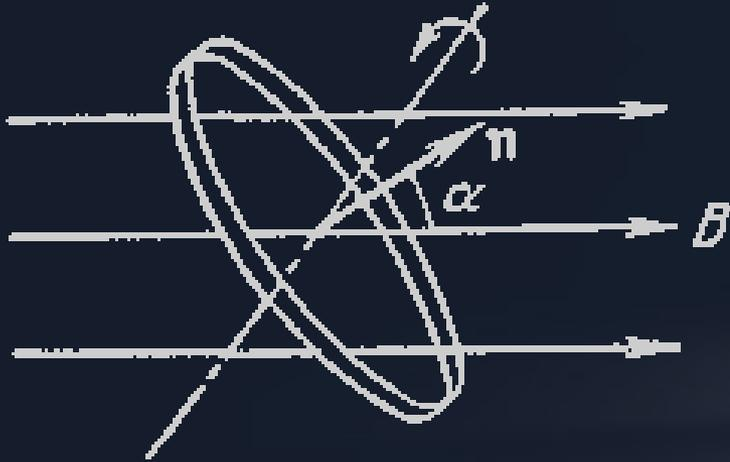
Катушка, имеющая  $N$  витков, вращается в однородном магнитном поле с постоянной скоростью  $\omega$ . Найдем индуцируемую в ней э.д.с. Поток через один виток  $\Phi = BS \cos \alpha$  где  $S$  — площадь витка,  $\alpha$  — угол между нормалью к плоскости витка и направлением  $B$ .
