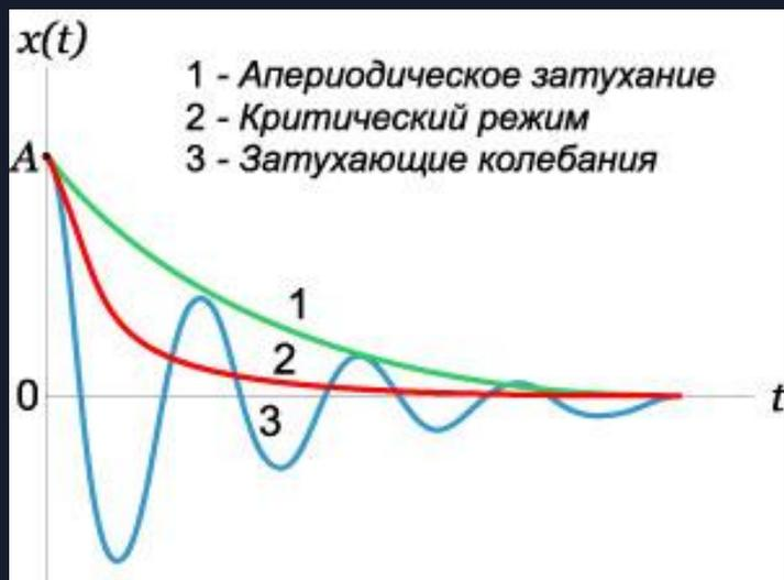
В заключение отметим, что при  $\beta^2 \geq \omega_0^2$ , т. е.  $\frac{R^2}{4L^2} \geq \frac{1}{LC}$ , вместо колебаний происходит апериодический разряд конденсатора. Сопротивление контура, при котором колебательный процесс переходит в апериодический, называется критическим. Значение критического сопротивления  $R_k$  определяется условием  $\frac{R_k^2}{4L^2} = \frac{1}{LC}$ , откуда
