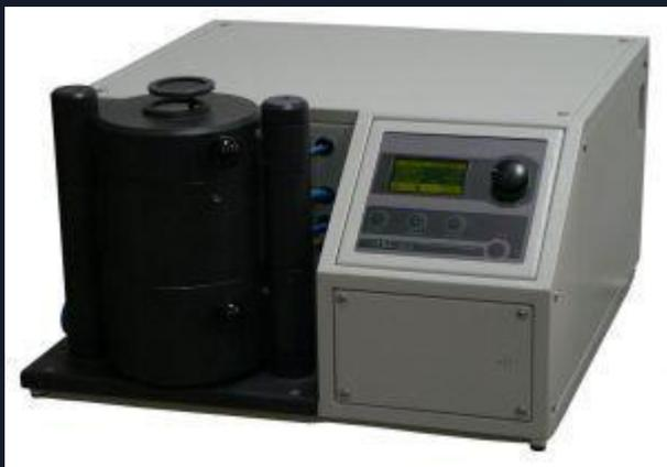
Настольная **вакуумная индукционная** литейная установка УЛВК-30МК предназначена для **индукционной плавки и литья в вакууме**, с **последующим прессованием сжатым воздухом или аргоном зубопротезных сплавов**. Установка рассчитана на работу со сплавами драгоценных металлов и никель-кобальт-хром-молибденовых (Ni,Co,Cr,Mo) сплавов, за исключением титана.
