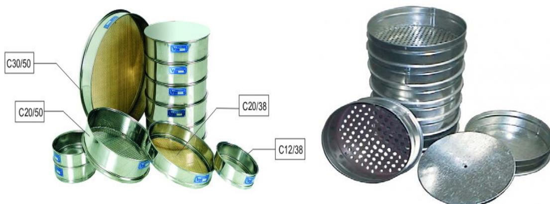
Рис.1 Сита для определения размера частиц почвы.
