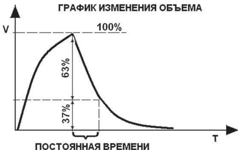
Данный график показывает, как современный аппарат ИВЛ рассчитывает постоянную времени. Бывает, что статический комплайнс рассчитать невозможно,
